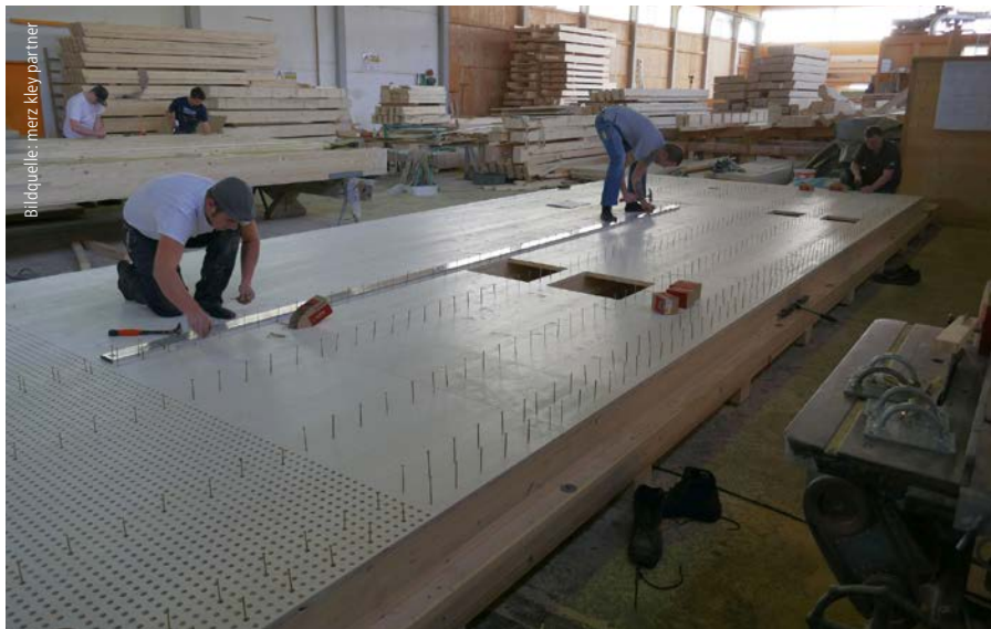
Ein in das Hohlkasten-Deckenelement integrierter, mittig angeordneter Querträger aus Buchen-Furnierschichtholz der Festigkeitsklasse GL75 lagert im Erdgeschoss auf BSH-Stützen und dient zugleich als Auflagerfläche für die Elemente des Obergeschosses.
