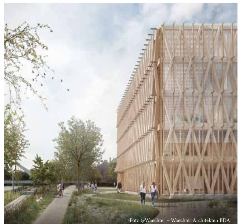
Struktur der Fassadenstützen dient der Gebäudeaussteifung
